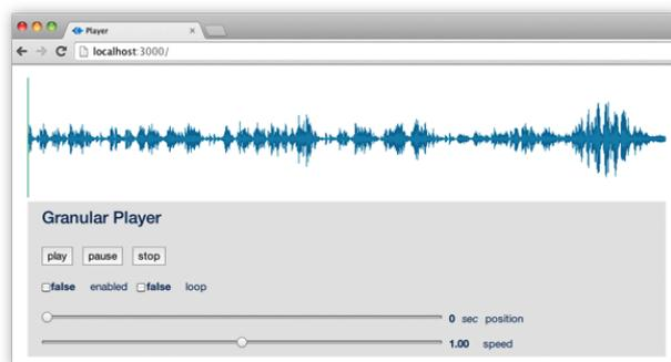
Figure : Affichage d'une forme d'onde calculée côté client par le navigateur sans extension et moteur audio de synthèse granulaire (créé à partir de la Web Audio API)
